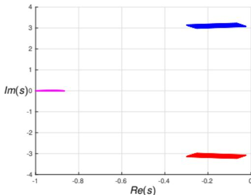
Figura 3: Raízes de  $D(s,a,b) = s^3 + bs^2 + as + 9$  com  $a \in [9,5 \ 10,5]$ ,  $b \in [1, \ 1,5]$ .
