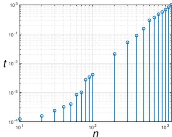
**Figura 1:** Tempo computacional médio para calcular as raízes de um polinômio de ordem  $n$  usando a função `roots` do Matlab. Os eixos estão escalas logarítmicas.
